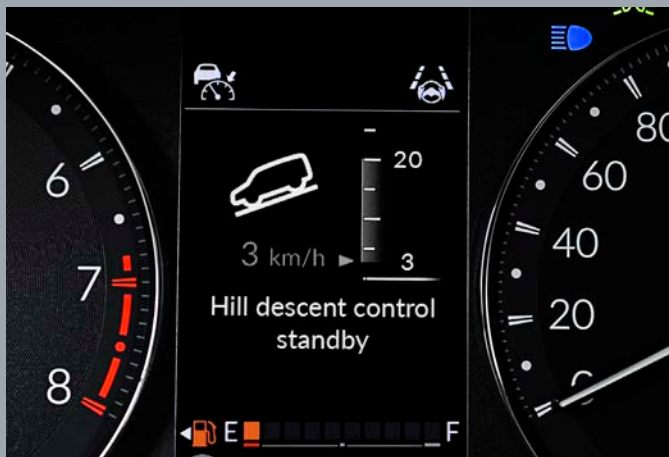
Le Contrôle en descente (HDC) contrôle automatiquement la vitesse entre 0 et 20 km/h lorsque vous descendez des côtes
