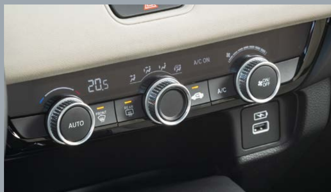
Climatisation automatique à boutons moletés (cliquer par toucher) avec un éclairage rouge et bleu
