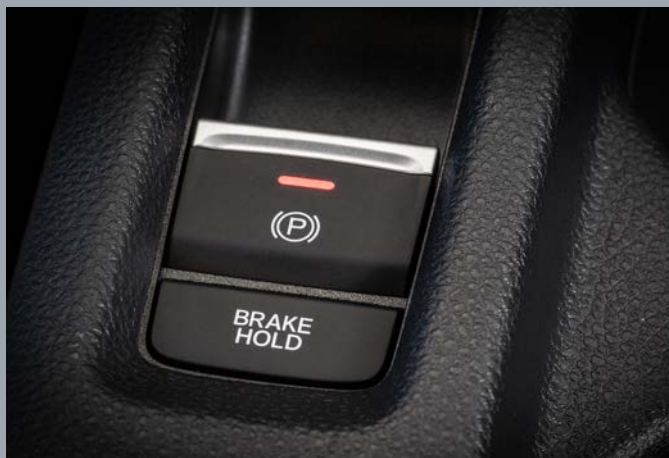
Frein de stationnement électrique (EPB) avec maintien du freinage
