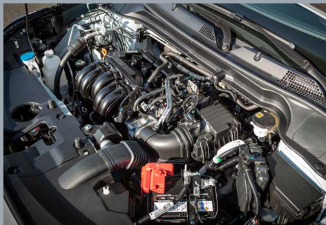
Moteur DOHC i-VTEC 1,5 L avec Transmission à Variation Continue (CVT)
