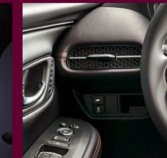
Appuyez sur le bouton de déverrouillage du hayon situé sur le tableau de bord pour ouvrir le hayon.
