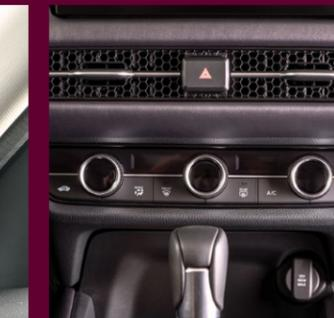
**Système d'air conditionné automatique à deux zones :**
